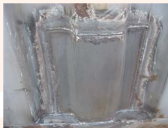
前旁板部分更换
